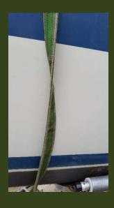
Verdrehungen und Knoten in den Gurten führen zu erhöhten Zugbelastungen in den Randbereichen. Dadurch kann die zulässige Belastung überschritten werden. Die Gurte werden unbrauchbar!
